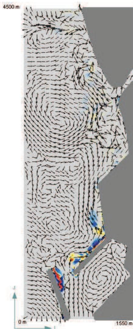
**Figura 15** Zone di deposito ed erosione- Andamento delle correnti per mareggiate provenienti dal settore meridionale (250°)
