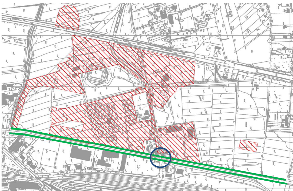
Fig. 5- Interventi di messa in sicurezza idraulica del Fosso Cigna, limitatamente alla sola area denominata Porta a Terra. Questi consistono nella realizzazione di alcuni nuovi tratti di arginatura (inerenti al tracciato indicato in verde) e nel rifacimento del ponte di Via dei Condotti Vecchi (cerchiato in blu).
