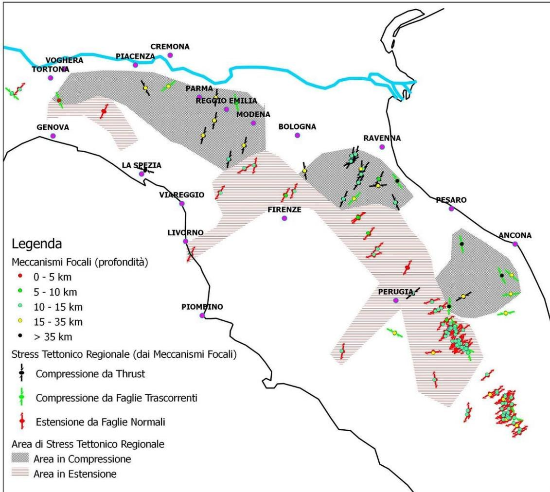
Fig. 21 Profondità dei meccanismi focali e suddivisione aree di stress compressivo ed estensivo
