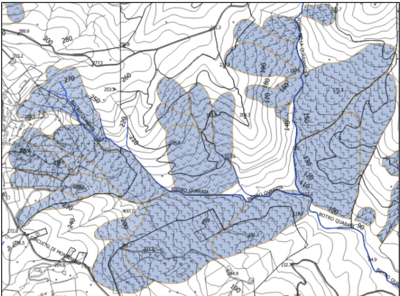
*in alto: ancora numerosi corpi di frana quiescente con movimento di scorrimento nei pressi del comparto di Montenero, presso il corso del Botro Quarata e Botro della Quarantola, con litotipi argilloscisti. Non rilevati nel PAI.*
