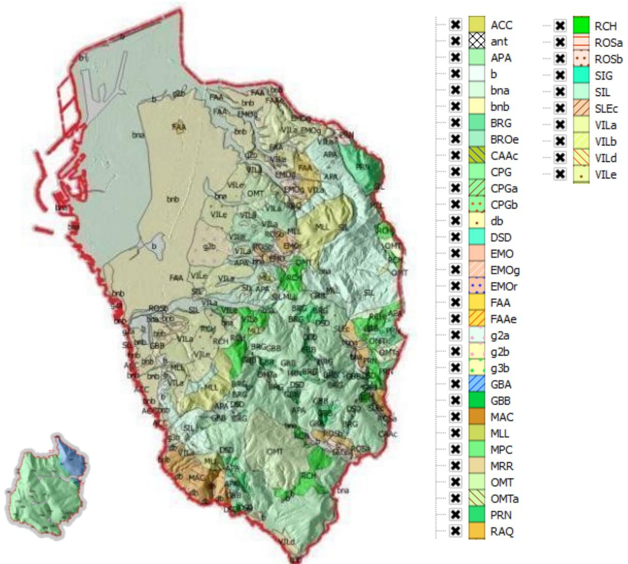
fig. 7 Ritaglio della cartografia geologica regionale (DBGR) sul confine del Comune di Livorno con sovrapposizione di 3D da dati LIDAR e colonna schematica della legenda informatizzata (isola di Gorgona in posizione non realistica). La Carta geologica di tav. 1 è stata aggiornata soprattutto per le formazioni pleistoceniche come da tab.A3 allegata.
