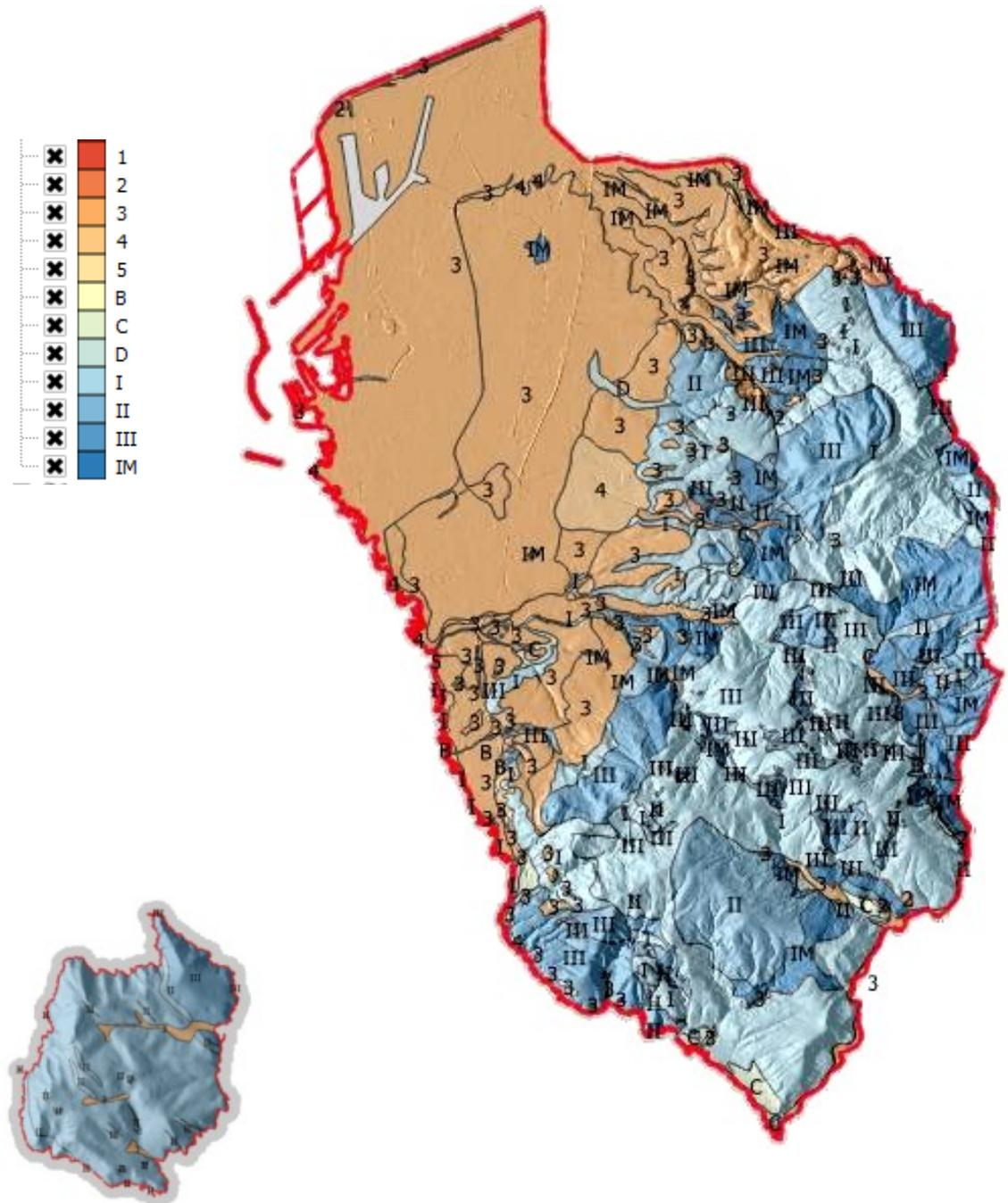
*Fig. 30 Schema di permeabilità (bozza senza isofreatiche) con sovrapposizione di 3D da dati LIDAR e colonna schematica della legenda informatizzata (isola di Gorgona in posizione non realistica). Per la legenda completa si vedano le pagine precedenti. In evidenza la differenza fra aree pianeggianti color marrone a permeabilità prevalente per porosità (primaria) ed aree collinari in azzurro a permeabilità prevalente per fratturazione (secondaria)*
