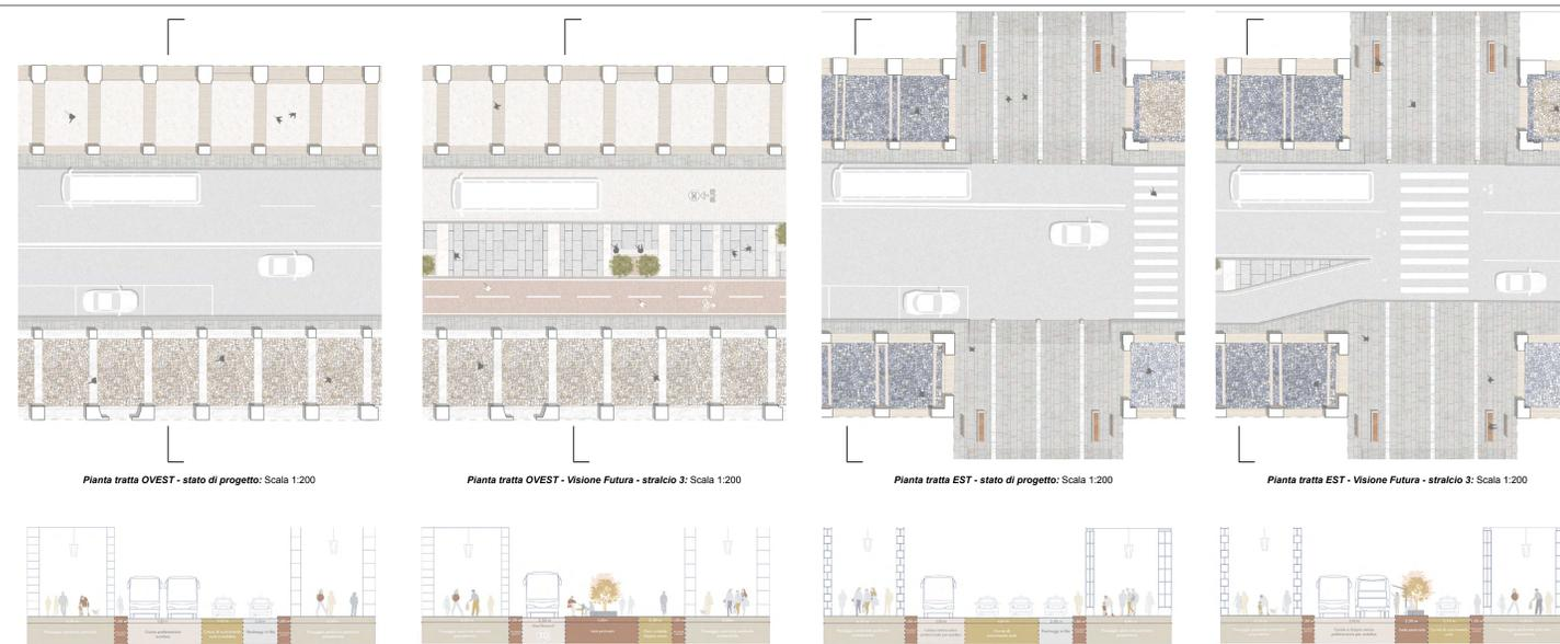
Schema mobilità - tratta OVEST - stato di progetto, Schema mobilità - tratta OVEST - Visione Futura - stralcio 3, Schema mobilità - tratta EST - stato di progetto, Schema mobilità - tratta EST - Visione Futura - stralcio 3
