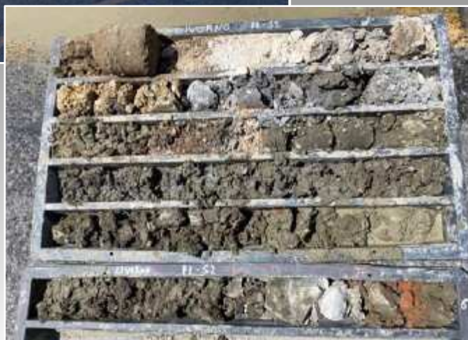
3. Cassetta catalogatrice del sondaggio per prelievo campioni materiali di riporto
