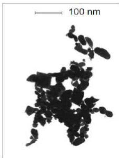
**Figura 46:** Immagine SEM di particelle di ferro zerovalente nanometriche.
