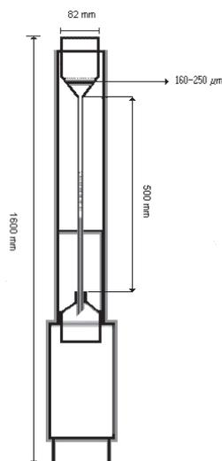
**Figura 1** – *Schema del campionatore tipo Bulk.*
