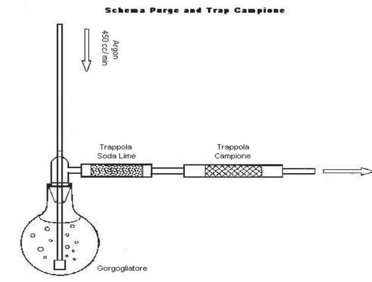
**Figura 3 – Schema della tecnica Purge and Trap**
